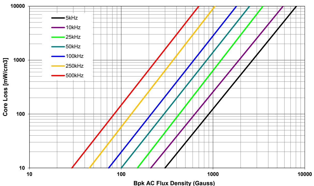
Abbildung 2: Kernverlustdiagramm bezogen auf die maximale Magnetflussdichte bei unterschiedlichen Frequenzen
