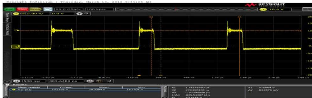
Abbildung 36: Messung der Spannung über der Schottky-Diode.
