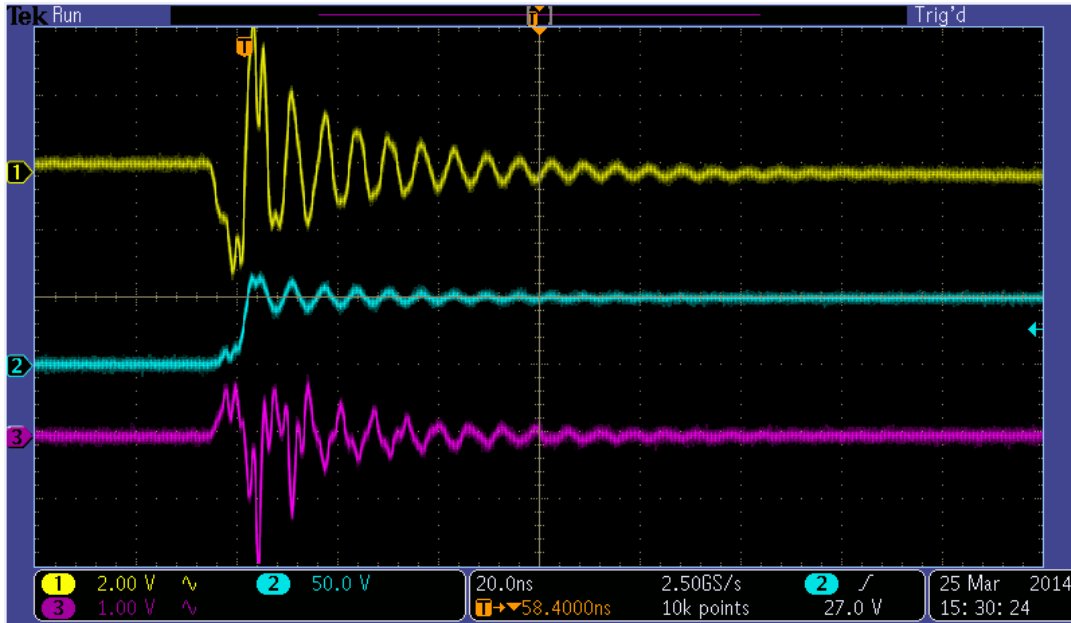
Abb. 6: Überschwngen des DC501A ohne Regelung der Änderungsgeschwindigkeit. V_{IN} = 48 \text{ V} , V_O = 12 \text{ V} , I_O = 6,0 \text{ A} K. 1 = V_{IN} AC-gekoppelt, K. 2 = Schaltknoten, K. 3 = V_O AC-gekoppelt
