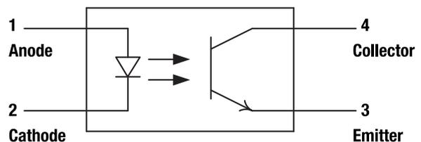
Abbildung 1: Würth Elektronik Optokoppler WL-OCPT mit zugehörigem Schaltbild
