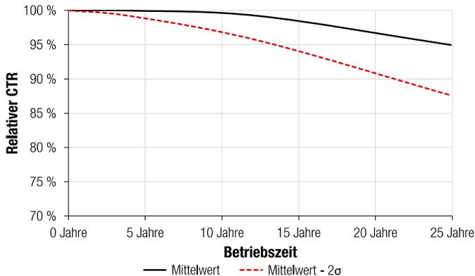
**Abbildung 2: Erwartete CTR-Reduzierung im Laufe der Betriebszeit. Parameter im normalen Betrieb: 100% Tastverhältnis, 80°C Umgebungstemperatur, 5 mA Vorwärtsstrom. Parameter während des Belastungstests: 1000 h Test, 110°C Testtemperatur, 30 mA Vorwärtsstrom**
