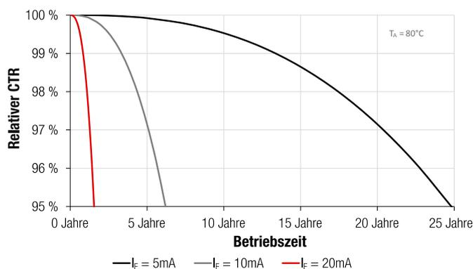
**Abbildung 3: Durchschnittliche CTR-Werte über der Betriebszeit in Abhängigkeit vom Diodenstrom  $I_F$  bei konstanter Umgebungstemperatur. Parameter im normalen Betrieb: 100% Tastverhältnis (= DC-Strom), 80°C Umgebungstemperatur, Dioden-Vorwärtsströme wie in der Grafik angegeben.**
