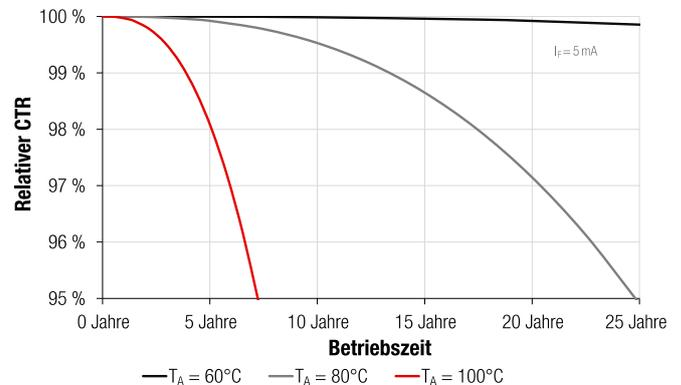
**Abbildung 4: Durchschnittliche CTR-Werte über der Betriebszeit in Abhängigkeit von der Umgebungstemperatur bei konstantem Diodenstrom  $I_F = 5$  mA. Parameter für den normalen Betrieb: 100% Tastgrad, 5 mA Vorwärtsstrom, Umgebungstemperaturen wie in der Grafik angegeben**
