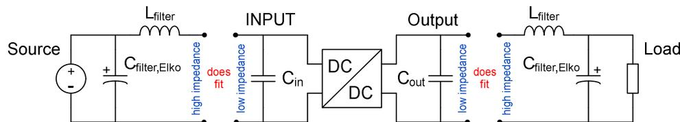
Abbildung 7: Darstellung der Ein- & Ausgangs Beschaltung für die Filterung von Gegentaktstörern
