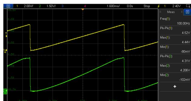
Abbildung 41:  $I_F$  und  $I_C$  im aktiven Bereich, der sich an den Extremen bis in den Sperrbereich (Cutoff) und die Sättigung erstreckt ( $V_{RF}$ ,  $V_{RC}$ )
