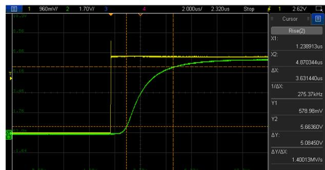
Abbildung 28: Einschaltbeispiel (WL-OCPT 817, Bin B) ( $V_{RF}$ ,  $V_{RC}$ )
