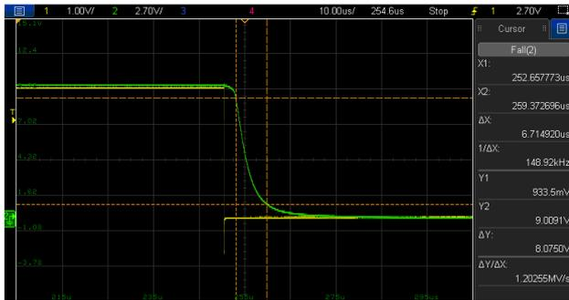
Abbildung 33: Ausschaltübergang (Bin D,  $V_{CE_{on}} = 1\text{ V}$ ;  $V_{RF}$ ,  $V_{RC}$  I)
