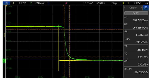
Abbildung 31: Ausschaltübergang (Bin A,  $V_{CE\_on} = 0,3\text{ V}$ ;  $V_{RF}$ ,  $V_{RC}$ )
