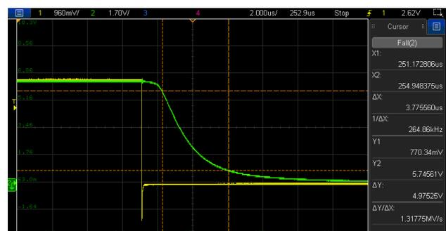
Abbildung 29: Ausschaltbeispiel (WL-OCPT 817, Bin B) ( $V_{RF}$ ,  $V_{RC}$ )
