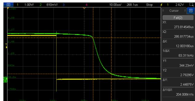
Abbildung 32: Ausschaltübergang (Bin D,  $V_{CE\_on} = 0,2\text{ V}$ ;  $V_{RF}$ ,  $V_{RC}$ )
